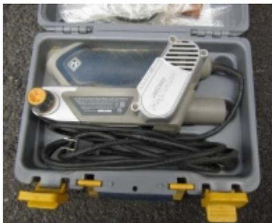
Ponceuse électrique à bande compacte Mastercraft Maximum pour bandes abrasives 2.5x16po, modèle 54-7242-4.
